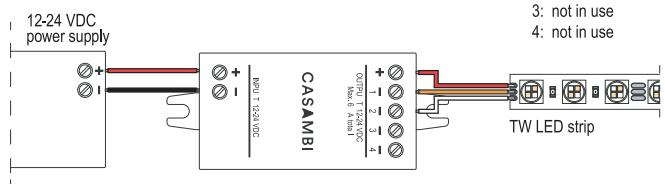
Schema elettrico, 1-4 canali separati
