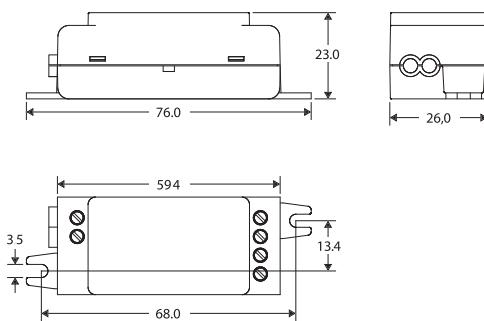
Controller a 2 canali abilitato Casambi Bluetooth. Il controller può pilotare 1 driver DALI oppure 2 driver 0/10, integrabile con funzione relay. Se accoppiato con Push oppure DALI sensor integra i dispositivi nella rete mesh in cui è configurato per le funzioni di presenza e gestione luminosa. Può essere controllato con l'app Casambi scaricabile gratuitamente dall'App Store di Apple e dal Google Play Store.
