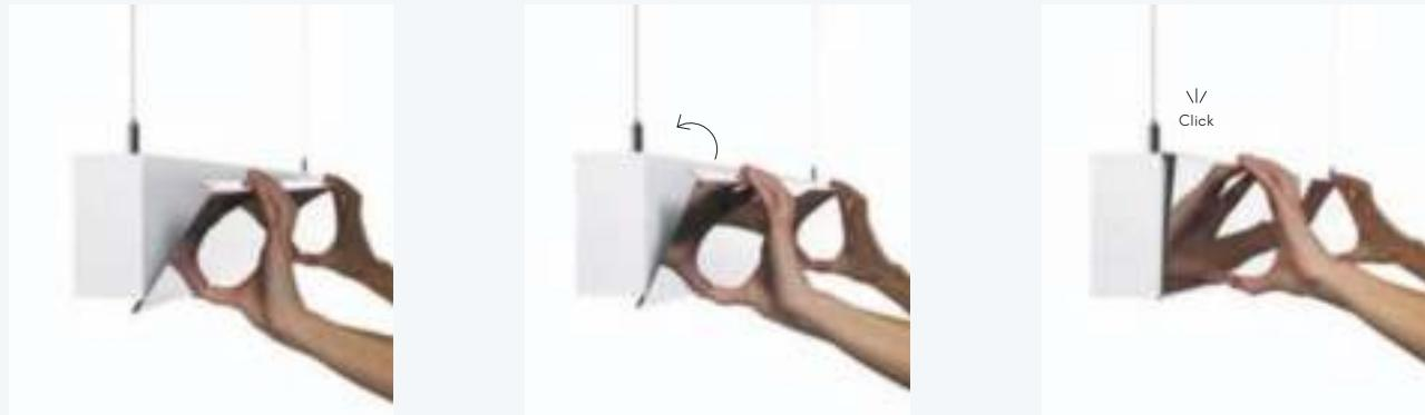
Il montaggio delle Steel Covers è a scatto e si effettua senza utensili. Le Steel Covers sono removibili, intercambiabili e si possono montare anche successivamente alla prima installazione. La lunghezza massima delle Steel Covers è di 1700 mm. I moduli di Karma e Segno più lunghi possono essere rivestiti con più lastre adiacenti.
