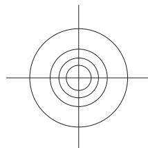
Le ottiche da 60° emettono luce in modo rotosimmetrico e sono ottimali per l'illuminazione da 8÷12 m. di metri di altezza.
