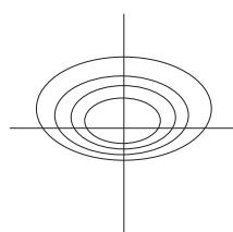
Le ottiche Asymmetric emettono luce prevalentemente di lato e sono indicate per l'illuminazione dei piani verticali come ad esempio gli scaffali di un magazzino o le pareti dei camminamenti.
