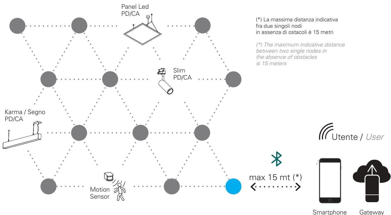
**Primo nodo:** riceve il segnale wireless da smartphone o da interfaccia utente e attiva la rete mesh
