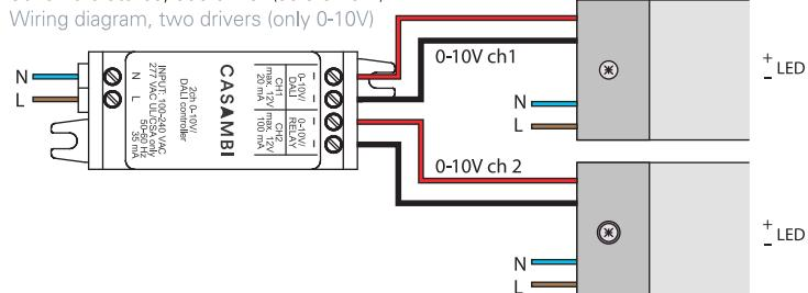
Schema elettrico, driver LED a 2 canali
